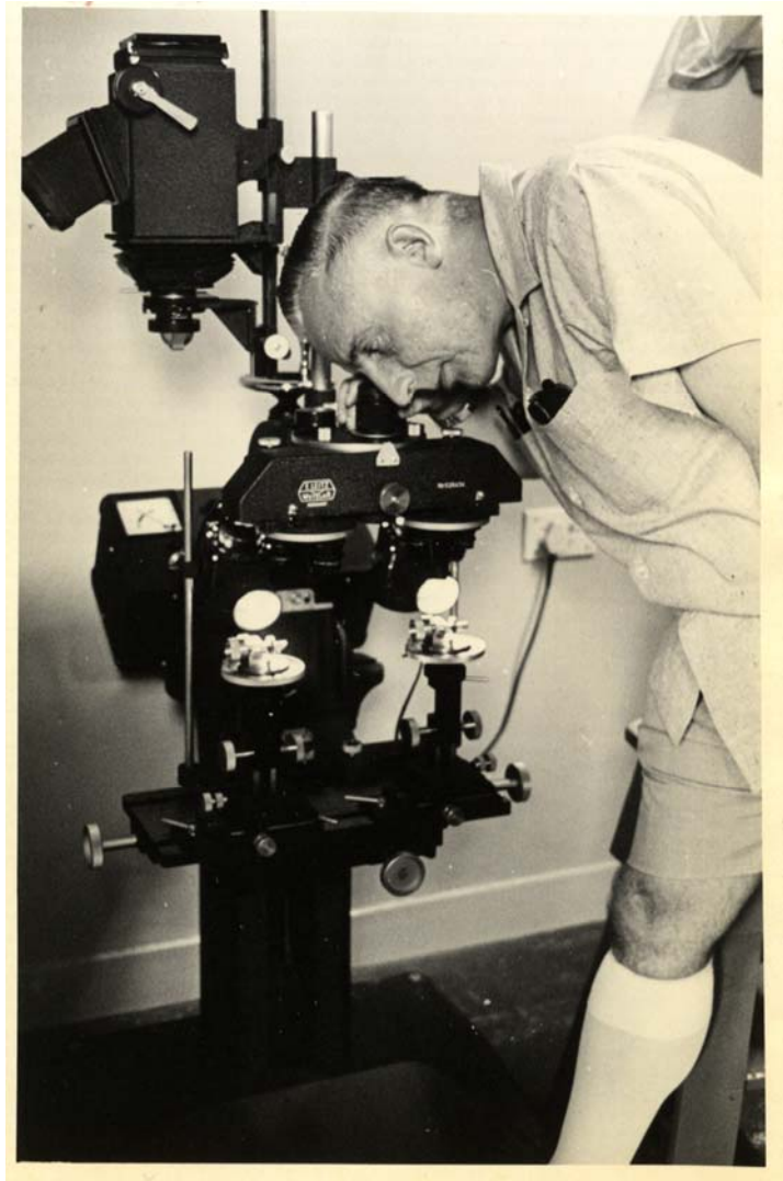
比对已发射子弹的主要仪器 Leitz 比对显微镜。退役后，现于警队博物馆展出
