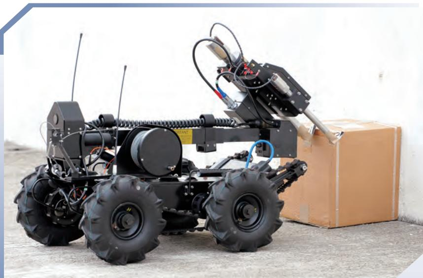
全新Delta独眼龙拆弹机械车配有无线控制系统，使警务人员可处身安全位置拆除土制炸弹。
