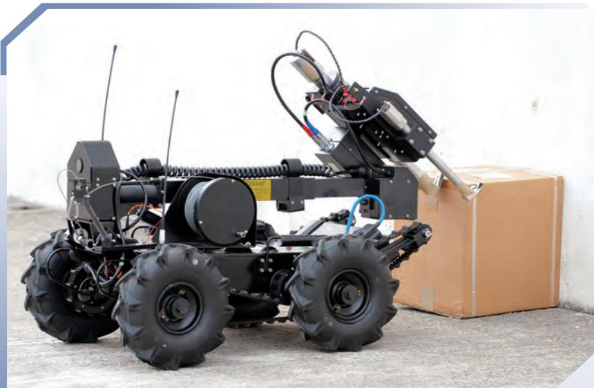
全新Delta獨眼龍拆彈機械車配有無線控制系統，使警務人員可處身安全位置拆除土製炸彈。
