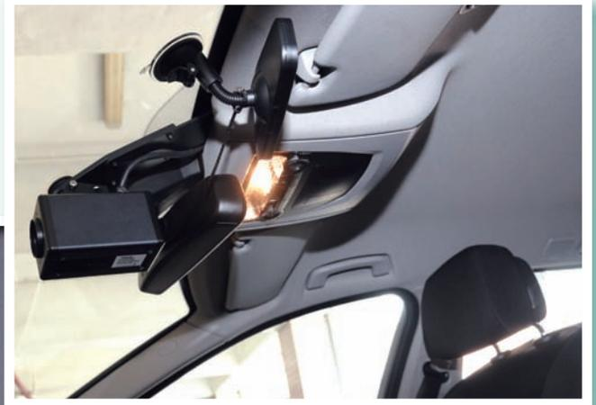
車內數碼視像系統，包括攝影機(右)及顯示屏(左)，偵測車速的準確度極高，提升警隊打擊超速駕駛的能力。
