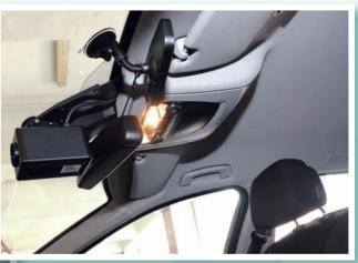
車內數碼視像系統,包括攝影機(右)及顯 示屏(左),偵測車速的準確度極高,提升 警隊打擊超速駕駛的能力。
